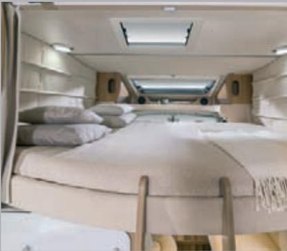
**Optionales Hubbett:** In fast allen Grundrissen besteht die Möglichkeit mit einem optionalen Hubbett über der Sitzgruppe weitere Schlafplätze an Bord zu schaffen. Das Hubbett ist mit manuellem oder elektrischem Hebe-/Senkmechanismus erhältlich. Wie alle Betten verfügt auch dieses über eine Mehr-Zonen-Kaltschaummatratze.
