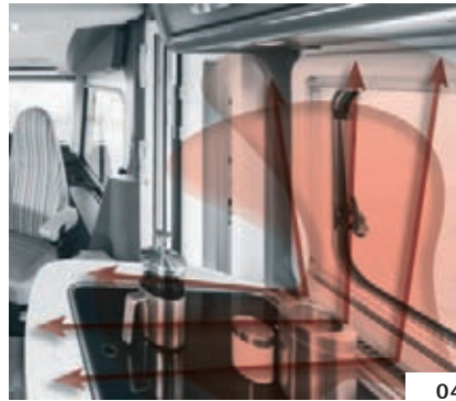
Küche: Warmluftauslass am Fenster
