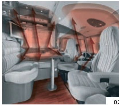
Wohnbereich: Warmluftauslässe am Fenster und unter der L-Sitzgruppe
