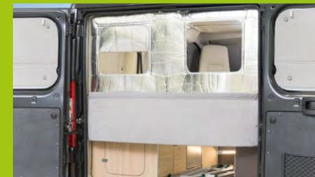
... und höhenverstellbarer Isoliereinsatz für den Heckbereich.
